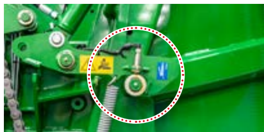
Bloqueo mecánico de la puerta trasera
